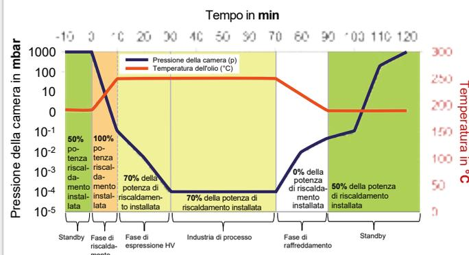
Consumo energetico ridotto al minimo durante l'intero ciclo di processo del forno con una gestione intelligente dell'alimentazione
