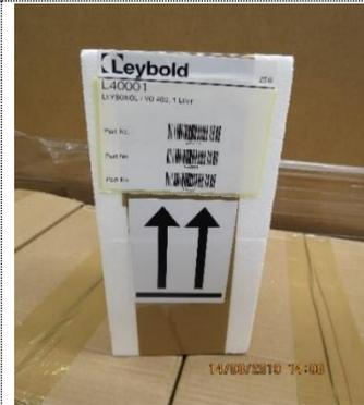
Beispiel LVO 400: Verpackung von einer Glasflasche in Polystyrol und Klebeband.
