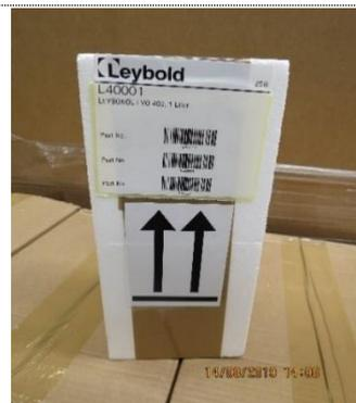
Exemple LVO 400 : Conditionnement d'une bouteille en verre dans du polystyrène et du ruban adhésif.
