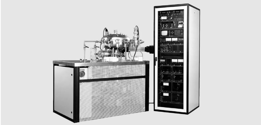
Kalibrieren von Vakuum-Messgeräten im Druckbereich von  $10^{-8}$  bis 1000 mbar als DAkkS- oder Werks-Kalibrierung.
