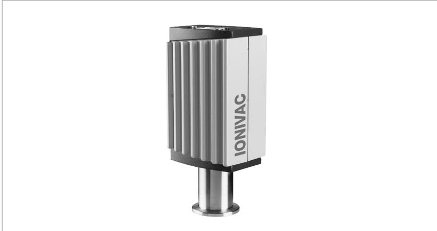
Der ITR 200 S ist ein optimierter Doppelkatoden-Kombinations-Transmitter auf Basis des bewährten ITR 90. Die Kombination eines Heißkatoden-Ionisationssensors nach Bayard-Alpert und eines Pirani-Sensors erlaubt Vakuumdruckmessungen von nicht entzündlichen Gasen und Gasmischungen im Druckbereich von  $5 \cdot 10^{-10}$  bis 1000 mbar.
