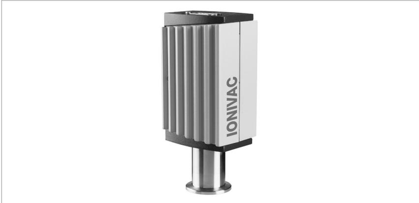
Der ITR 90 ist ein optimierter Kombinations-Transmitter. Die Kombination eines Heißkatoden-Ionisationssensors nach Bayard-Alpert und eines Pirani-Sensors erlaubt Vakuumdruckmessungen von nicht entzündlichen Gasen und Gasmischungen im Druckbereich von  $5 \cdot 10^{-10}$  bis 1000 mbar.
