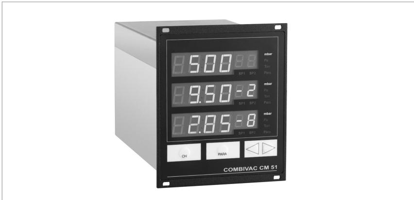
Das COMBIVAC CM 51 bietet durch die Kombination von zwei Messprinzipien (Absolutdrucksensor THERMOVAC und PENNINGVAC) eine lückenlose Messung des Vakuumdruckes zwischen  $10^{-9}$  und 1000 mbar sowie Kontroll- und Steuerfunktionen.
