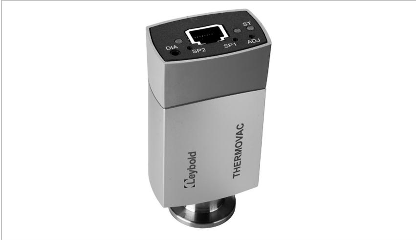
Der Pirani Kapazitäts-Vakuumsensor ist der erste Vakuumsensor, in dem das Prinzip der Kapazitäts-Messung über eine keramische Membran mit dem Prinzip der Druckmessung über die Wärmeleitfähigkeit kombiniert wird. Der Leybold Transmitter TTR 101 bietet eine überlegene Genauigkeit und die Möglichkeit gasartunabhängiger Messungen im Druckbereich zwischen 10 mbar und 1500 mbar.
