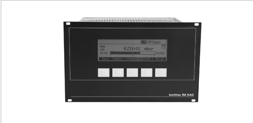
Das Drei-Kanal-Anzeige- und -Betriebsgerät IONIVAC IM 540 deckt durch die Kombination von bis zu vier unterschiedlichen Messprinzipien – Pirani, Kapazitiv, Bayard-Alpert und Extraktor – den gesamten Vakuummess- und Regelbereich zwischen  $10^{-12}$  mbar und Atmosphärendruck ab.
