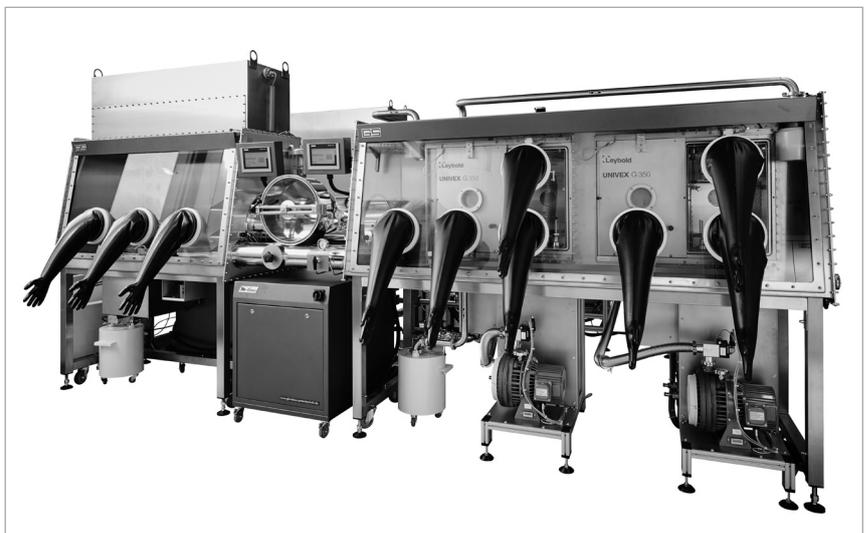
Glove-Box-Anlage mit rückseitig angebauten Beschichtungsmodulen UNIVEX G 350
