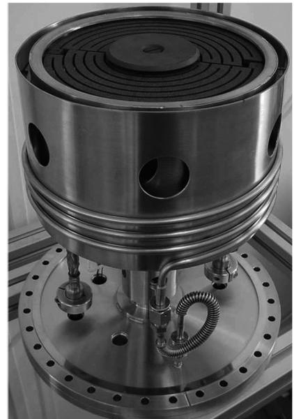
Rotierender Hochtemperatur-Strahlungsheizer mit SIC-Heizelement
