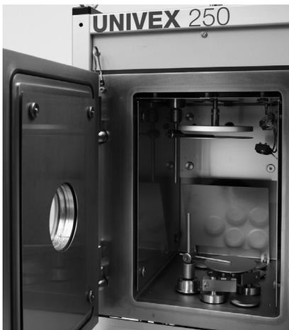
Kammerboden: thermischer Doppelverdampfer mit Quellenblende
