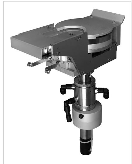
Elektronenstrahl-Verdampfer mit 6fach-Drehtiegel
