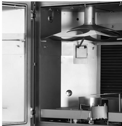
An der Kammerdecke rotierende Substrat-Kalotte mit zentraler Messung der Schichtdicke auf Schwingquarzbasis. Kammerboden: Elektronenstrahl-Verdampfer mit Mehrfach-Wechseltiegel und Ionenquelle.
