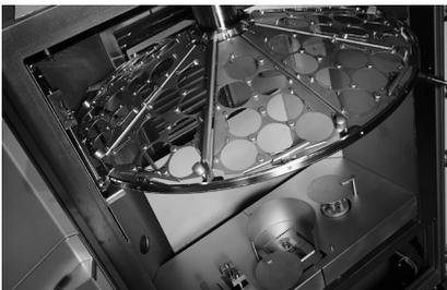
Kammerboden: Elektronenstrahl-Verdampfer, thermischer Verdampfer, Ionenquelle
