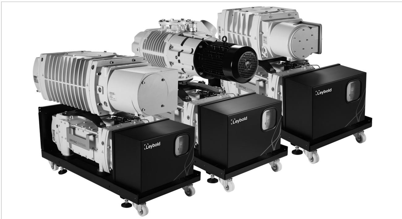
Die 2-stufigen DRYVAC-SYSTEME sind Kombinationen trockenverdichtender Wälzkolben- und Schraubenpumpen. Die auf der Vorvakuumpumpe montierte RUVAC dient der Steigerung des Saugvermögens (Booster).
