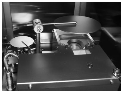
Elektronenstrahl-Verdampfer mit 4-fach-Drehtiegel sowie zusätzlicher thermischer Doppelverdampfer, jeweils mit Quellenblende
