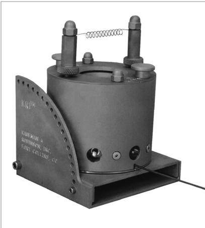
Gitterlose DC-Ionenquelle mit Filament zur Plasma-Neutralisierung
