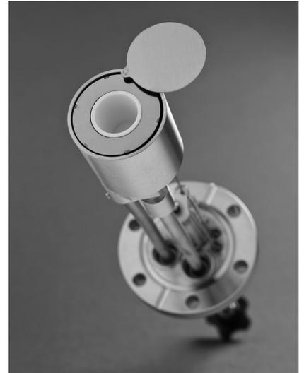
Einzelner Organik-Verdampfer mit Blende, montiert auf Flansch DN 40 CF
