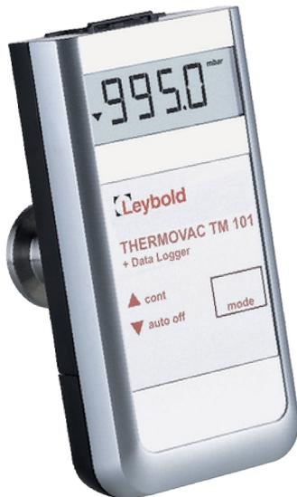
Das temperaturkompensierte Handmessgerät THERMOVAC TM 101 ist mit einem Piezo/Pirani Kombinationssensor ausgerüstet und dient zur Absolutdruckmessung im Bereich von 1200 bis  $5 \cdot 10^{-4}$  mbar.
