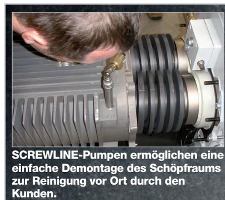
**SCREWLINE-Pumpen ermöglichen eine einfache Demontage des Schöpfraums zur Reinigung vor Ort durch den Kunden.**
